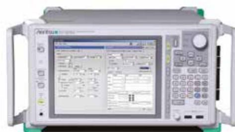
Анализатор качества сигналов MP1800A – это измерительный прибор, обеспечивающий анализ коэффициента ошибок по битам и качества для последовательных цифровых сигналов непосредственно от 100 Мбит/с до 32 Гбит/с с возможностью увеличения до 64 Гбит/с. Благодаря модульной конструкции, анализатор качества сигналов серии MP1800A – это экономичное решение для выполнения измерений при идеальном коэффициенте битовых ошибок.
