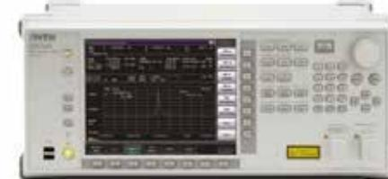
Благодаря диапазону от 600 нм до 1750 нм, анализатор MS9740A может использоваться для решения широкого круга задач, включая измерение оптических устройств, проведение анализа сигналов WDM и EDFA, а также оценку изменения оптического уровня.
